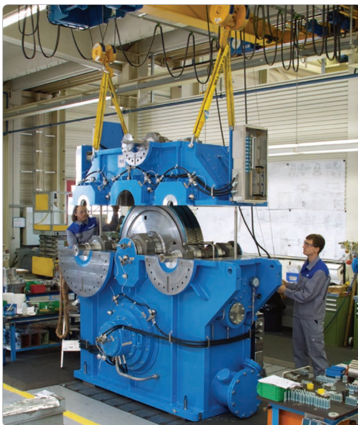
Mehrwellen-Integralgetriebe mit Druckkammer: Zentraler Baustein der Fertigung in Kompetenzzentren ist bei Voith eine belastbare Zeitwirtschaft mit Lösungen von HSi.
